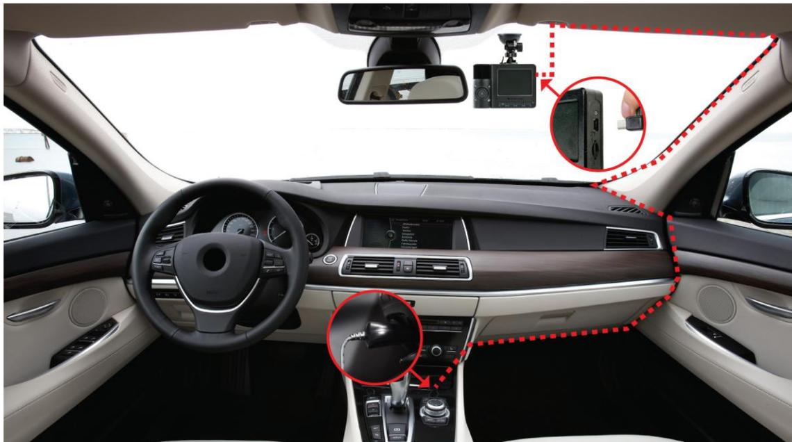
1. Conecte el extremo pequeño del adaptador de vehículo al conector USB del DrivePro.
