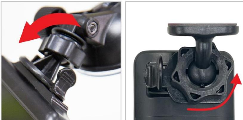
5. DriveProの位置が決まったら、調節ノブを時計回りに回して固定します。その場所にDriveProがしっかりと安全に固定されていることをご確認ください。
